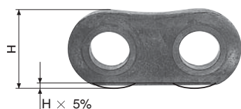
Fig. 24 Desgaste nas bordas das placas dos elos
