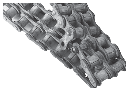
Fig. 31 Corrosão de corrente de roletes em aço inoxidável
