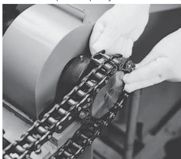
Fig. 8 Fazendo a conexão com uma roda dentada
