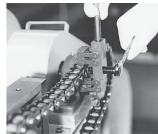
Fig. 5 Aqueça para cortar a corrente usando um parafuso de corrente
