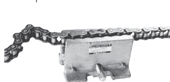
Fig. 3 Fixando a corrente de roletes na morsa de correntes
